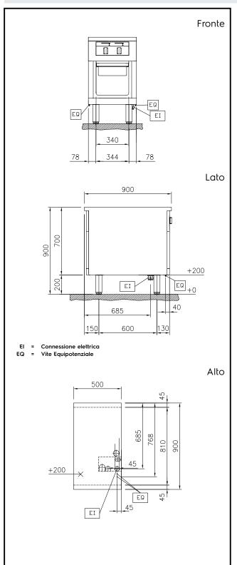
**Elettrico** Tensione di alimentazione: 400 V/3N ph/50/60 Hz Watt totali: 6 kW Informazioni chiave 80 °C Temperatura MIN: Temperatura MAX: 350 °C Dimensioni esterne, larghezza: 500 mm Dimensioni esterne, profondità: 900 mm Dimensioni esterne, altezza: 700 mm Peso netto: 98 kg Su Base;Funzionante da un Configurazione: Sostenibilità
